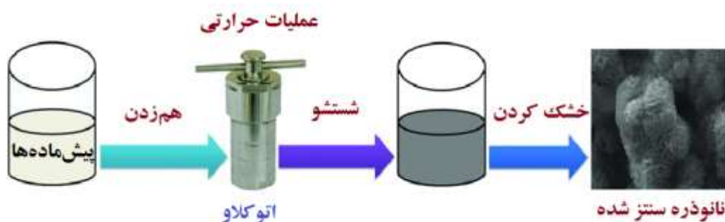
شکل ۲- شمایی از فرآیند هیدروترمال برای سنتز نانوساختارهای سولفید مولیبدن ( \text{MoS}_2 )
