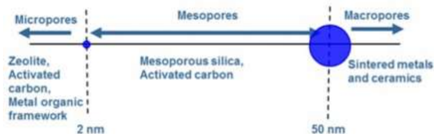
شکل ۱- دسته‌بندی آیوپاک بر اساس اندازه حفره [۱].
