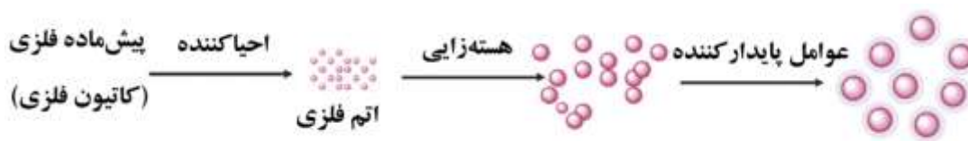
شکل ۱- شمایی از مراحل روش احیا شیمیایی
