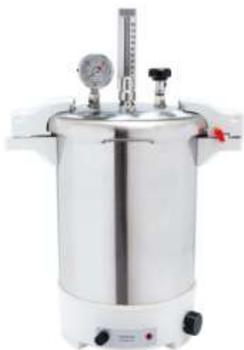
شکل ۳- تصویری از یک اتوکلاو بکار رفته در فرآیند هیدروترمال
