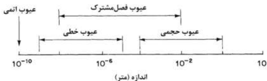
شکل ۱- عیوب مختلف در بلور و بازه اندازه‌ی آن‌ها [۱]
