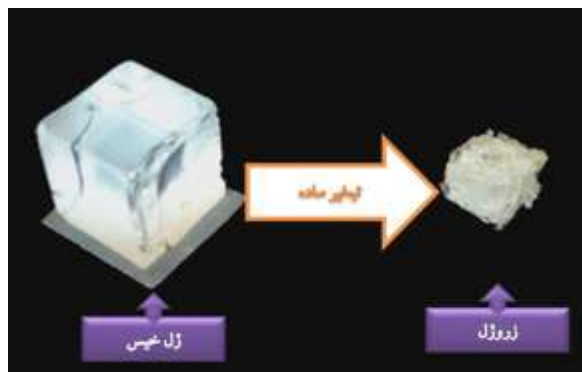
شکل ۶- خشک کردن به وسیله تبخیر ساده و تولید زروژل [۵]
